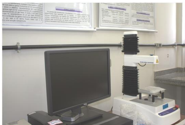
Imagem 9. Equipamento para análise de textura (Texturômetro)
