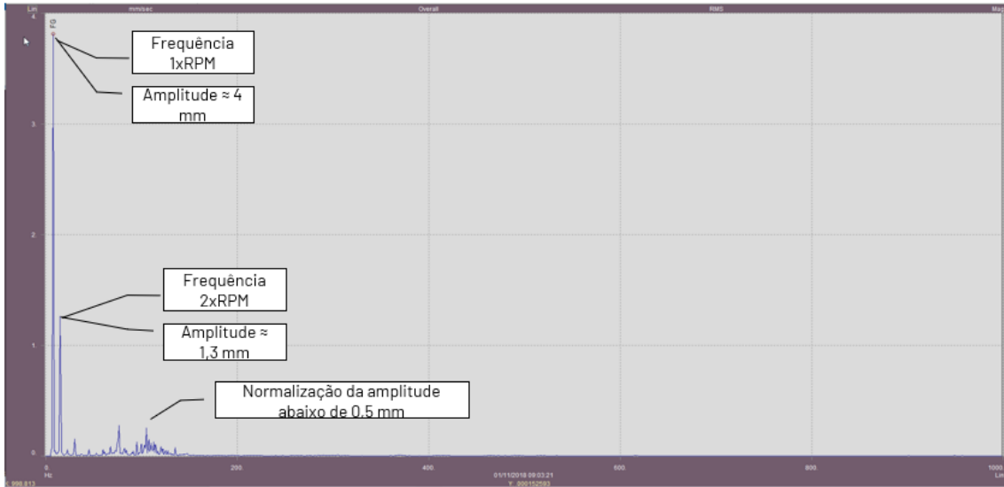
Figura 55: Espectrometria de desalinhamento do motor
