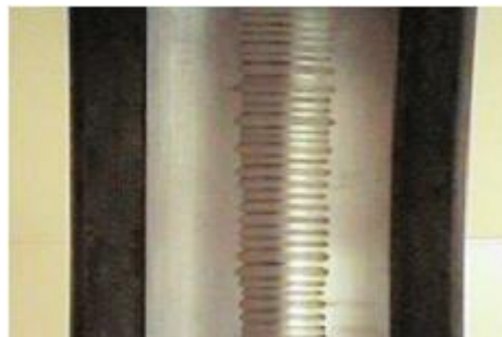
Figura 62: Usinagem por descarga elétrica na pista de um rolamento.[28]
