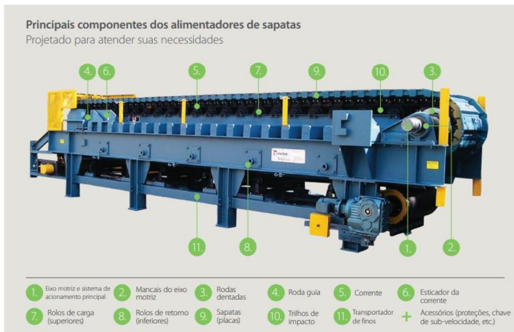
Figura 25: Principais componentes do alimentador de sapata.[5]
