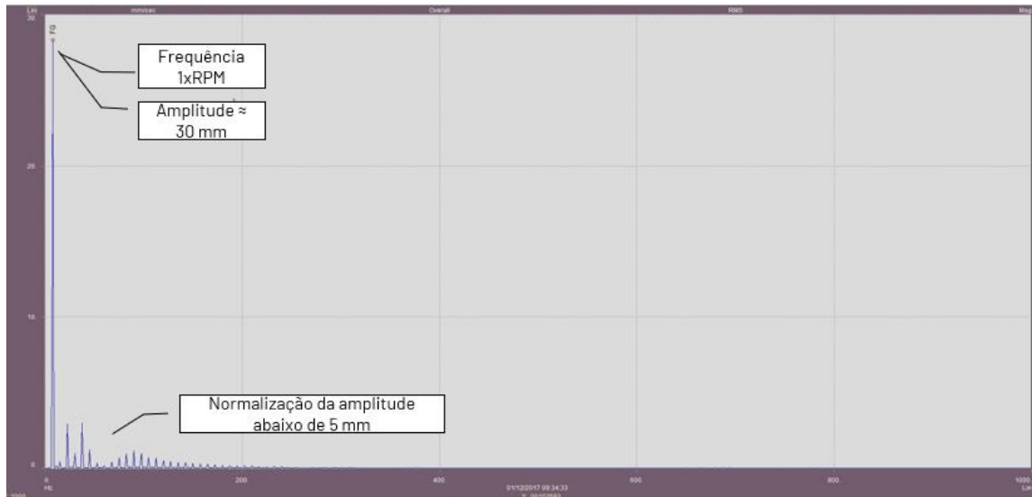
Figura 49: Espectrografia de rotor do moinho desbalanceado.
