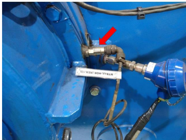
Figura 45: Sensores conectados ao lado livre do motor
