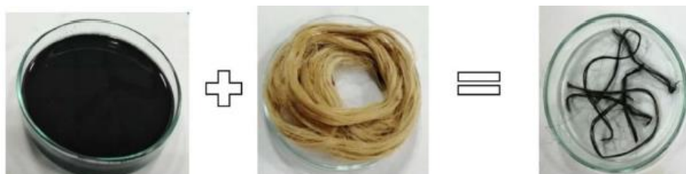
Figura 9: Fibras de juta tratadas e funcionalizadas com nanotubos de carbono.
