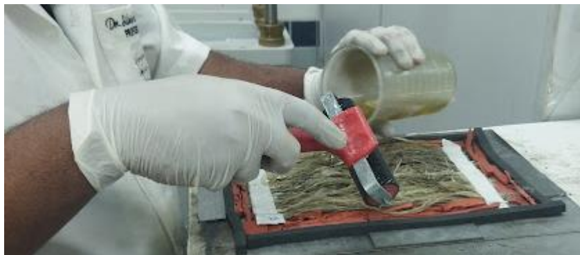
Figura 35: Aplicação da matriz nas fibras de curauá posicionadas no molde
