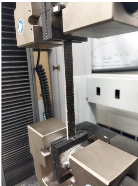
Figura 39: Ensaio de tração sendo realizado em um corpo de prova de compósito EJCNT. Fonte: autor
