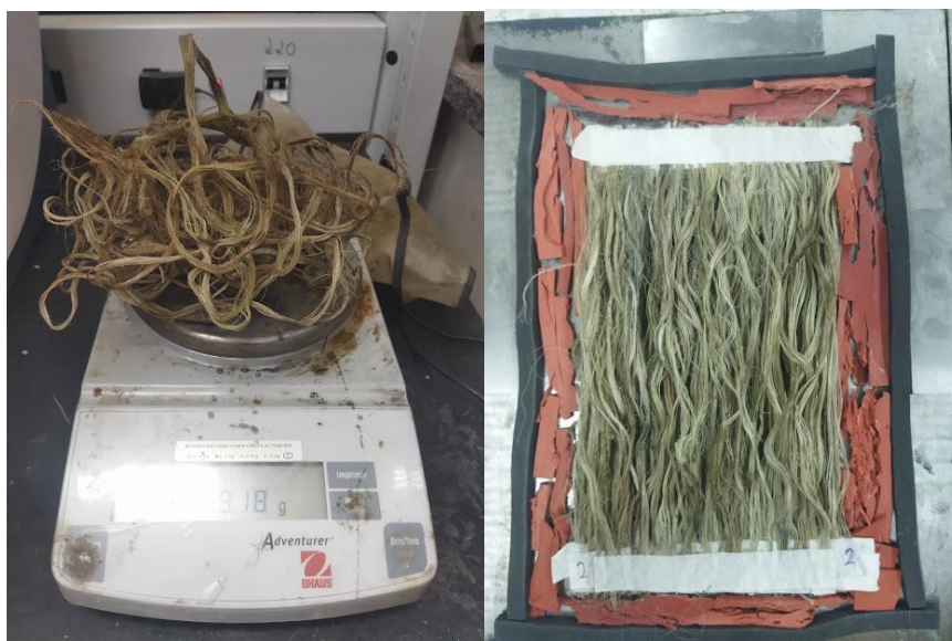
Figura 34: (a) Fibras de curauá sendo pesadas; (b) Fibras de curauá em ordenamento unidirecional fixadas ao molde.
