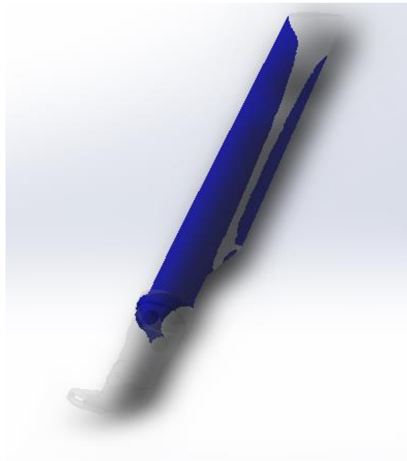
Figura 56- Região de maiores carregamentos - Do autor (SolidWorks)
