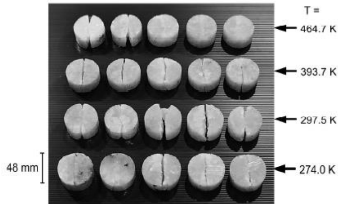
Figura 26: Corpos de prova após ensaio brasileiro realizado em diversas temperaturas (SRIAPAI et al. , 2012).
