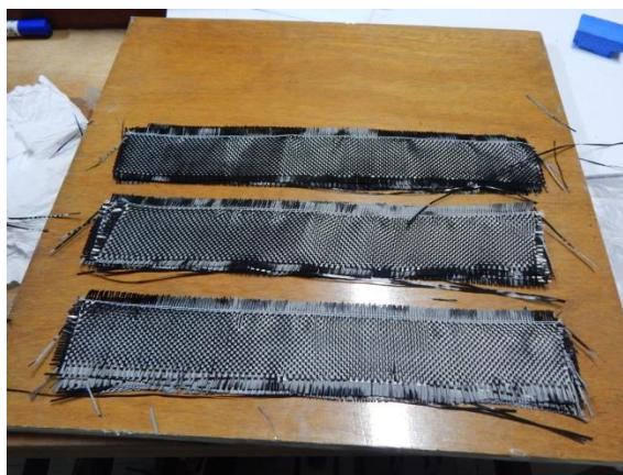
Figura 28: Ilustração do corte da manta de fibra de carbono.
