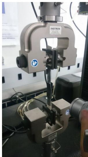
Figura 20: Foto de um corpo de prova sendo ensaiado no Laboratório de Compósitos e Adesivos (LADES), CEFET-RJ.
