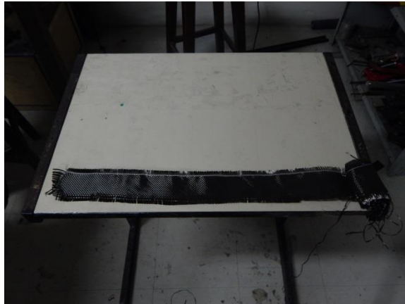
Figura 27: Preparação da superfície para laminação.
