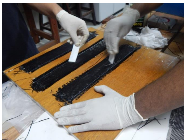
Figura 30: Colagem das camadas de manta de fibra de carbono.
