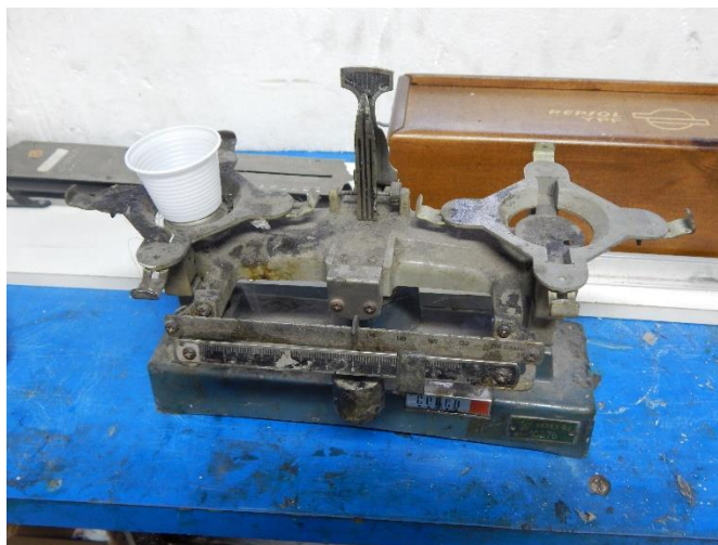
Figura 29: Ilustração da medição de adesivo bi-componente epóxi.
