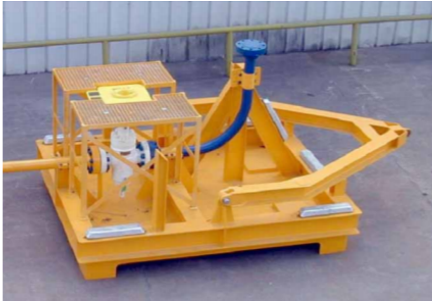
Figura 6: Estrutura típica de um PLET. Fonte: [PETROBRAS, 2015]
