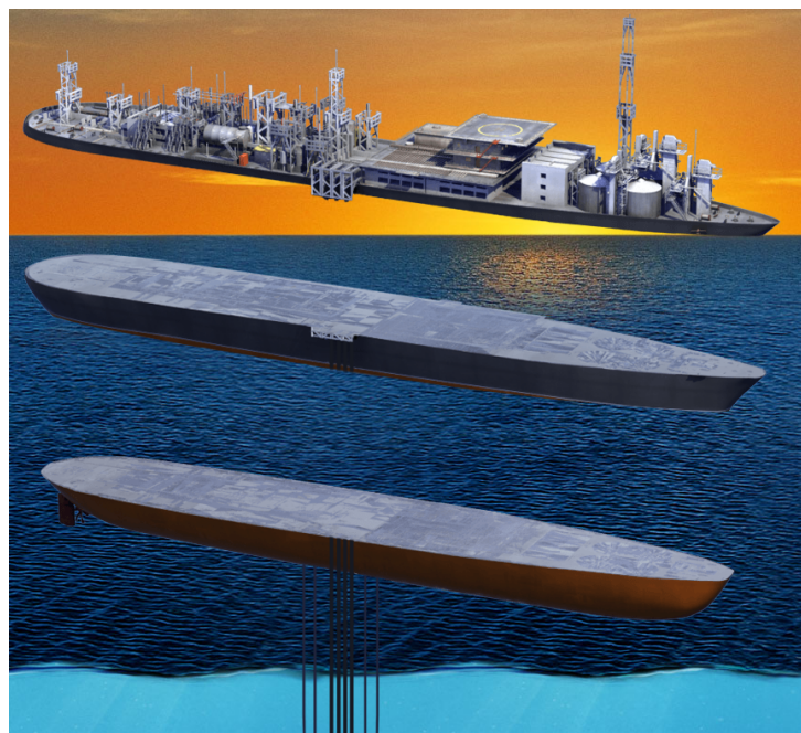
Figura 7: Diferentes camadas de um FPSO. Fonte: [PETROBRAS, 2019]
