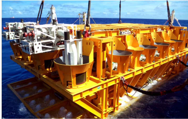
Figura 3: Estrutura típica de um manifold . Fonte: [PETROBRAS, 2015]
