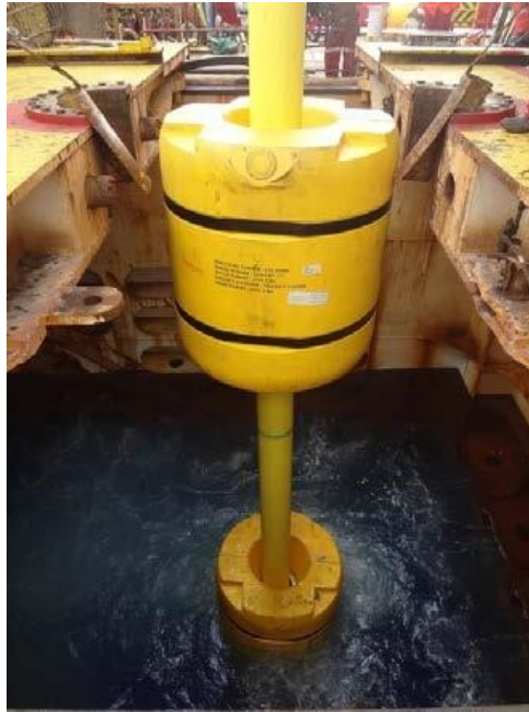
Figura 13: Flutuador para sistemas de instalação em lazy wave .
