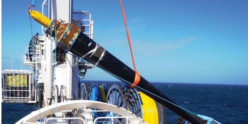
Figura 11: Exemplo de enrijecedor. Fonte: [BALMORAL, 2021]
