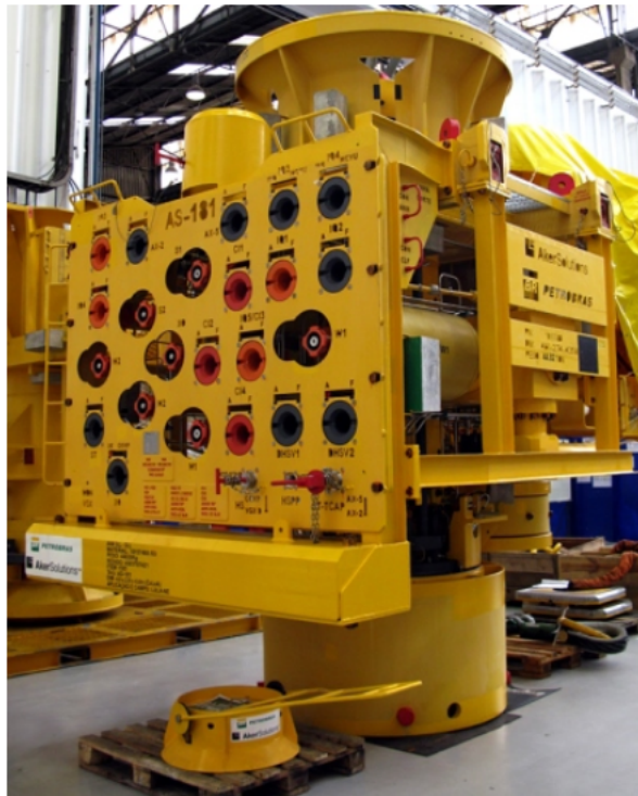
Figura 2: Estrutura típica de uma árvore de natal molhada.
