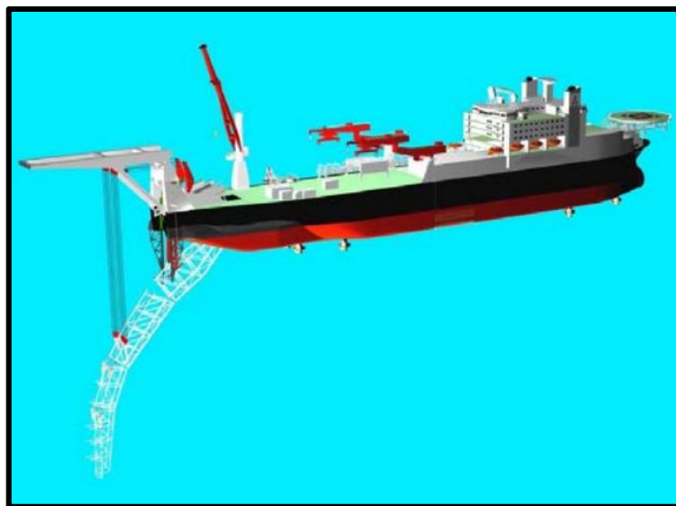
Figura 8: Verticalização na saída do stinger [5].
