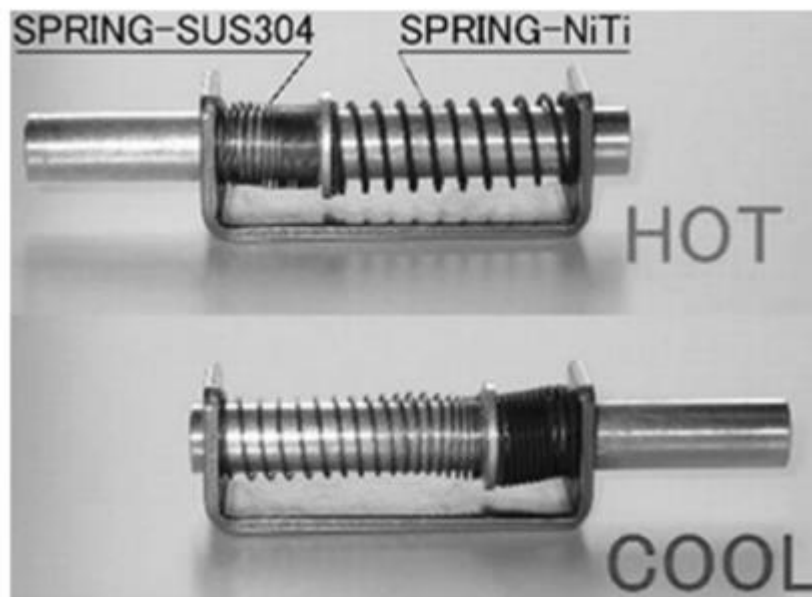
Figura 7- Atuador SMA típico (Nespoli et al. ,2010)
