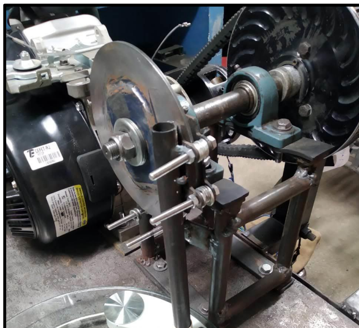
Figura 3-3: Sistema de freio da bancada atual Fonte: Os autores (2022)
