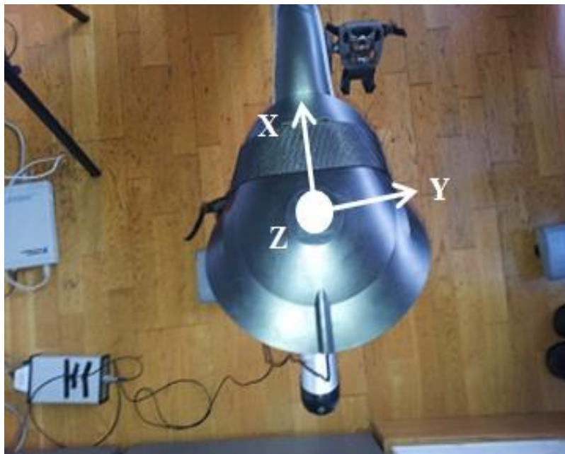
Figura 3.7 - Acelerômetro na interface selim-corpo humano.
